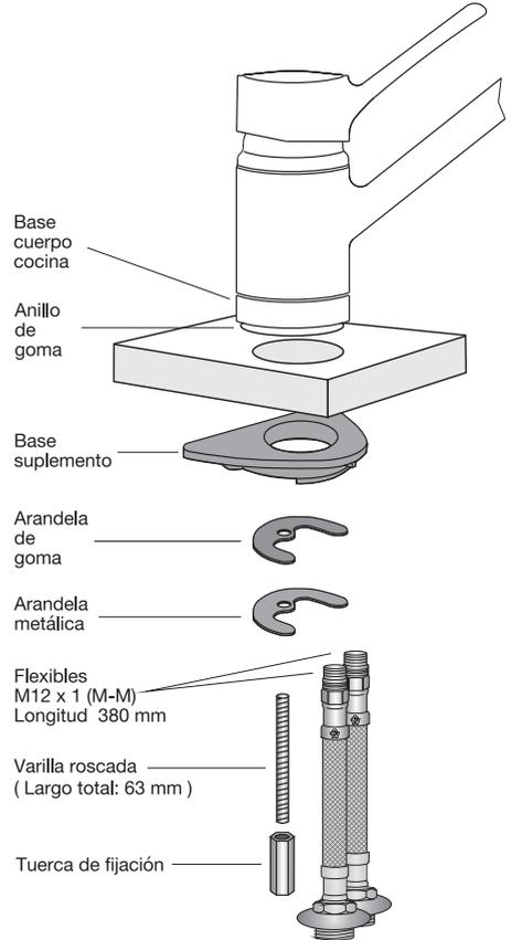
Ubique el anillo de goma debajo de la base del cuerpo de cocina. Bajo mesada coloque: la base suplemento, las mangueras flexibles, la arandela de goma y la arandela metálica. Luego ajústelas mediante la varilla roscada y la tuerca de fijación.
